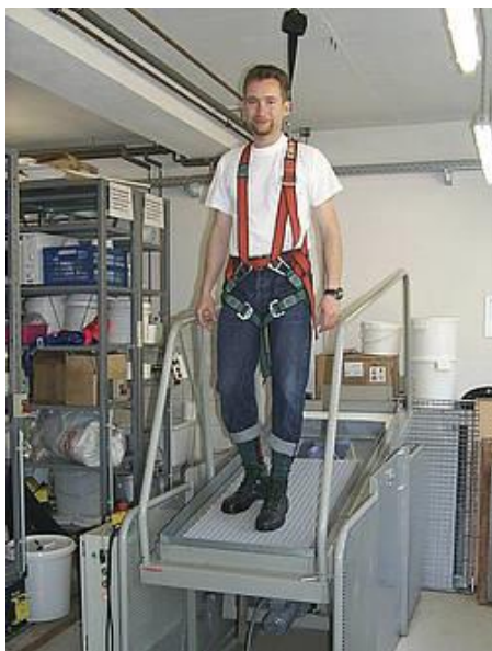
5B1. Tabella di classificazione dello scivolamento ed esempio di test su pavimentazione reale secondo norma DIN 51130
