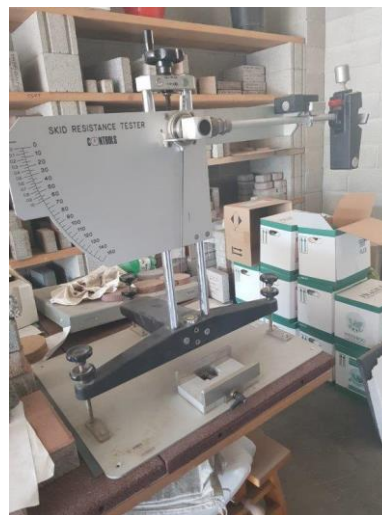
5A1. Apparecchiatura per prova del BRITISH PENDULUM ed esempio di test su prodotto.
