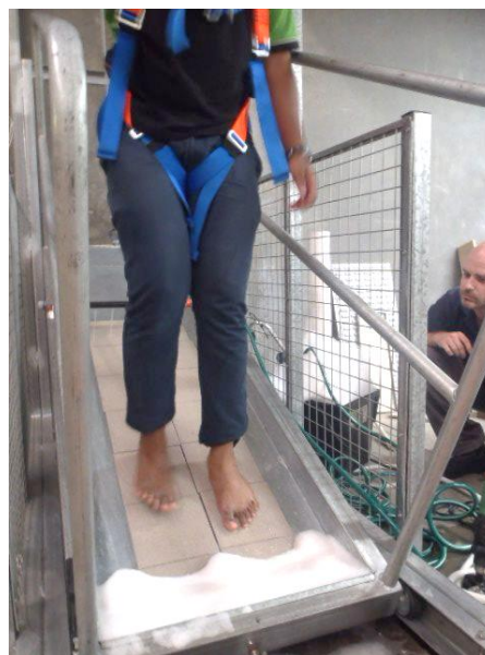
5B1. Tabella di classificazione dello scivolamento ed esempio di test su pavimentazione reale secondo norma DIN 51097
