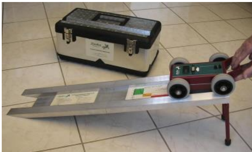
5C1.Esempio di test con pattino secondo B.C.R.A. Rep. CEC. 6-81
